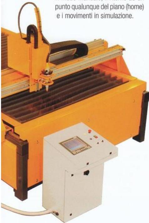
Un database espandibile permette di selezionare con una sola operazione la velocità, la corrente di taglio, la tensione d'arco, l'altezza di sfondamento e tutti i parametri di lavorazione per ottenere il miglior risultato di taglio.
